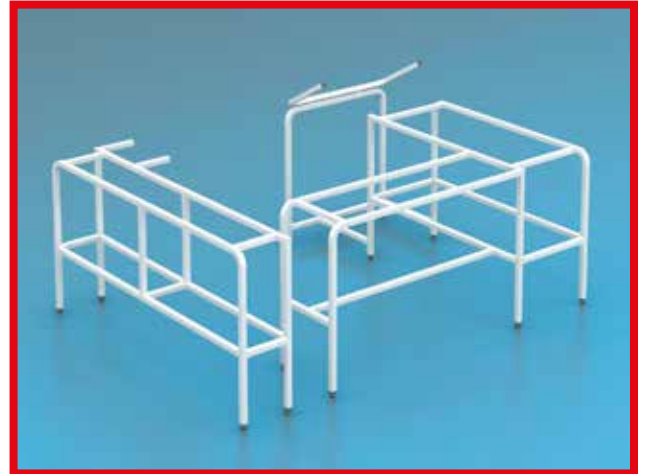
Makina tezgahı iskelet montajlı görünüşü
